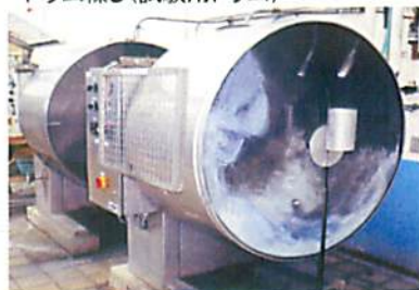
ドラム鞣し(試験用ドラム)
